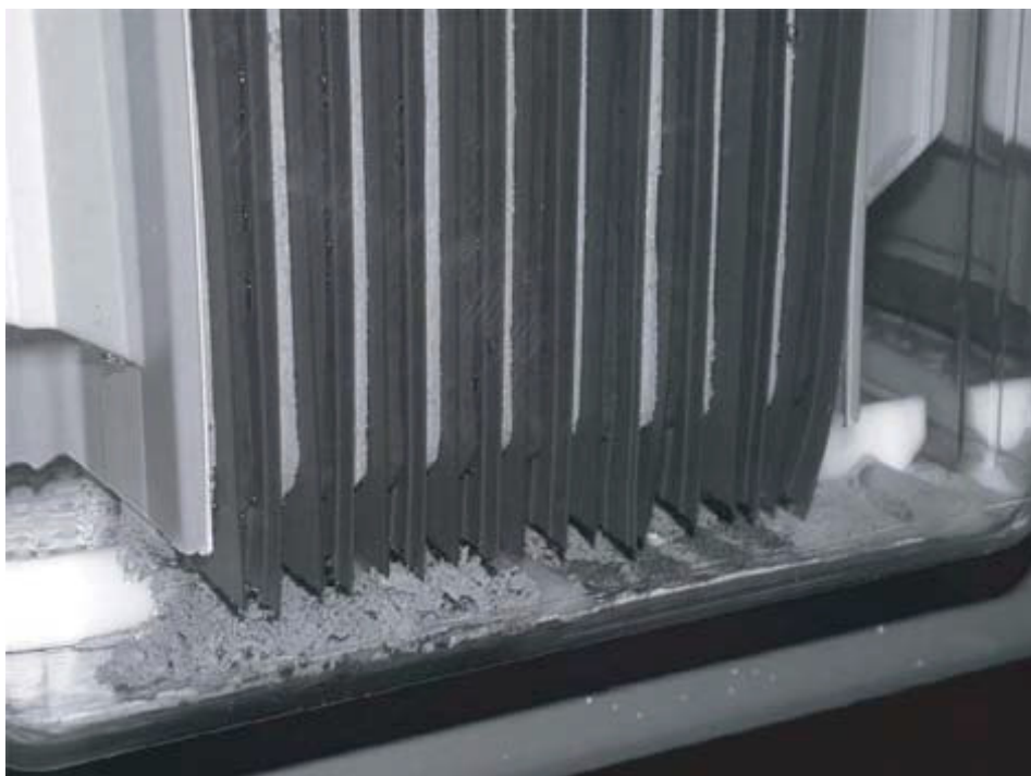
شکل (۴): رسوبات ته نشین شده در کف سلول به علت شارژ غیر صحیح [۷].
